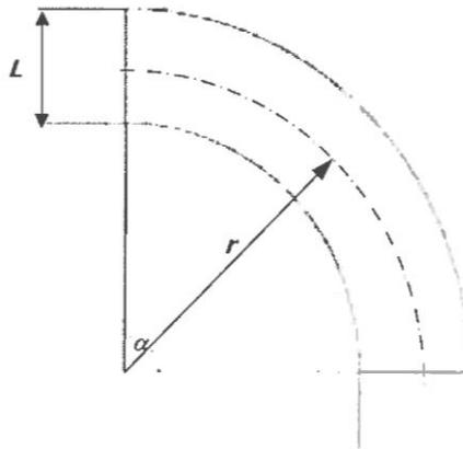
fig. 1 — rappresentazione schematica dei requisiti di curva minima
