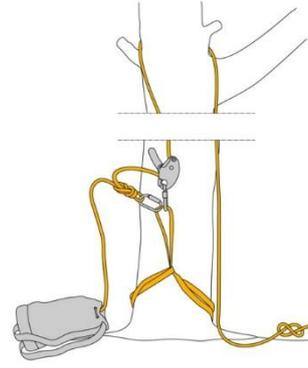
Fig. 6 - Ancoraggio della fune alla base dell'albero
