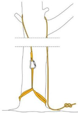
Fig. 5 - Ancoraggio della fune con dispositivo passante
